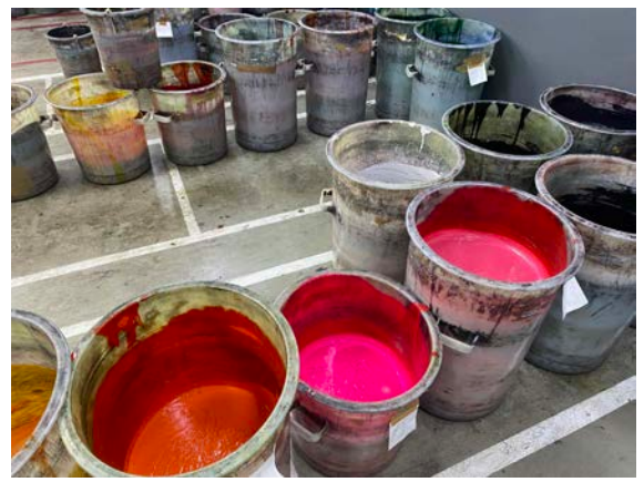
In der Druckerei werden spezielle, Cradle-2-Cradle zertifizierte Farbstoffe für den Rotationsdruck abgemischt.
